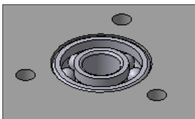
Рис. 26.26. Правильно установленный подшипник в плате
